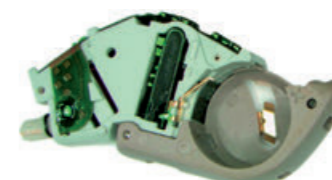
Hörsystem MIT iSolate nanotech nach mehreren Wochen in einer Feucht- und Wärmekammer
