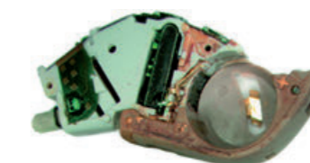
Hörsystem QHNE iSolate nanotech nach mehreren Wochen in einer Feucht- und Wärmekammer
