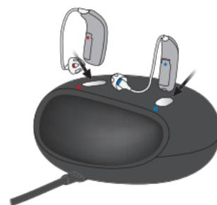
Setzen Sie die Hörsysteme wie im Bild gezeigt in die Ladeschalen.
